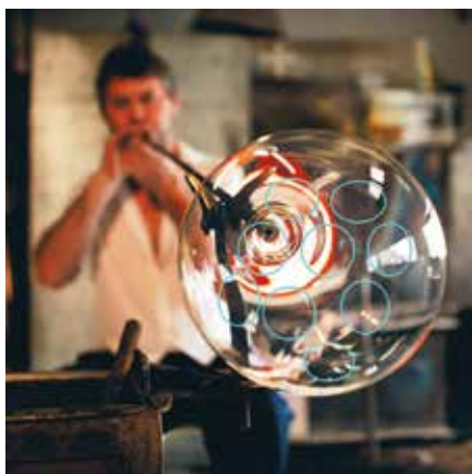
Abbildung 4: Im Mittelalter wurden aus einer frisch geblasenen Glaskugel durch Kälte kleine Scheibchen – hier als Kreise angedeutet – herausgebrochen und auf der konkaven Seite glattgeschliffen. Das Brillenglas war fertig.
