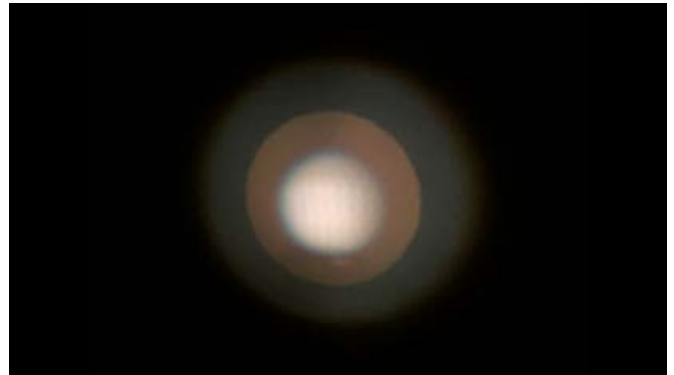
Abbildung 4b: Anordnung wie in Abbildung 4a, ein anderer Brennpunkt wird fokussiert. Abweichungen in Farbe und Größe der defokussierten Brennpunkte fallen auf.
