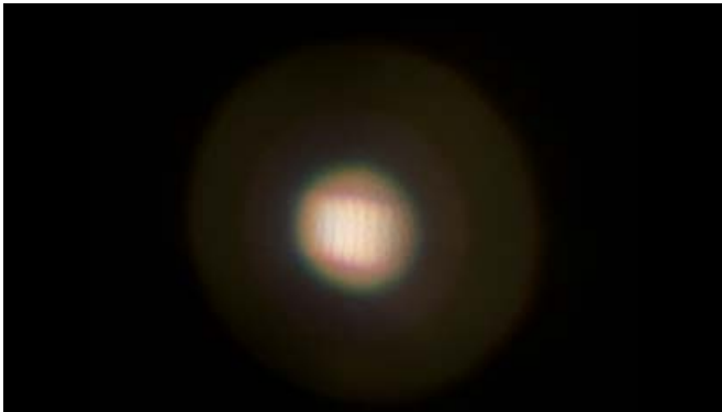
Abbildung 4a: Durch ein diffraktives optisches Element wird Licht einer Visitenlampe auf eine Wand projiziert (senkrecht durch das Zentrum der Zonenplatte), das Glühwendel und die Multifokalität sind zu erkennen. Die Abbildungen durch die Brennpunkte der 2., 3. und 4. Ordnung sind defokussiert, größer, dunkler und konzentrisch angeordnet. Diese Abbildung entspricht der Lichtverteilung auf der Netzhaut bei einer gut zentrierten diffraktiven multifokalen Linse.
