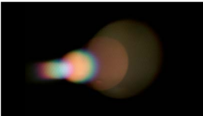
Abbildung 4c: Anordnung wie in Abbildung 4a und b, parazentrale Projektion. Die Abbildungen durch die Brennpunkte der 2., 3. und 4. Ordnung sind dezentriert. Die farblichen Abweichungen der unterschiedlichen Abbildungen fallen stärker auf. Diese Abbildung entspricht der Lichtverteilung auf der Netzhaut bei einer dezentrierten diffraktiven multifokalen Linse und können sehr stören.
