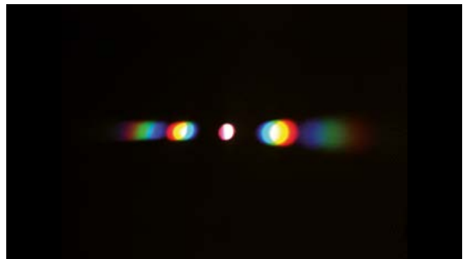
Abbildung 4d: Anordnung wie in Abbildung 4a bis c, weiter parazentrale Projektion. Die farblichen Abweichungen der unterschiedlichen Abbildungen fallen noch stärker auf. Eine derartige Dezentrierung ist nach der Implantation einer diffraktiven multifokalen Linse nicht zu erwarten.
