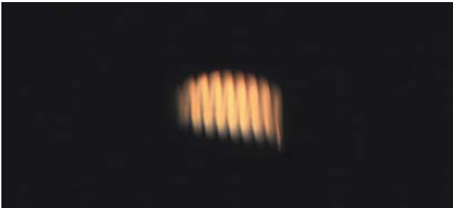
Abbildung 3: Wenn Licht einer Visitenlampe durch eine asphärische Linse (z. B. 14-dpt-Ophthalmoskopier-Lupe) auf eine Wand projiziert wird, ist das Glühwendel deutlich zu erkennen, egal ob durch das Zentrum oder die Peripherie der Linse projiziert wird. Die sich überlagernden Spiegelungen in der Linse (wie in Abbildung 2) sind so schwach, dass sie auf dem Foto nicht zu sehen sind.
